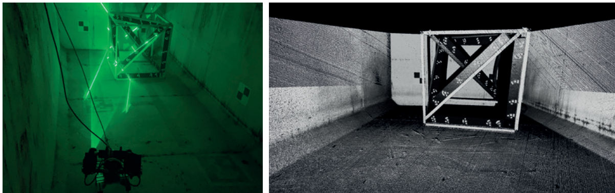
Abb. 10 | Ein 1\text{ m} \times 1\text{ m} \times 1\text{ m} großer Würfel mit auf Glasplatten gedruckten Markern als Referenzpunkte. Rechts ein Scan des Würfels aus 3,2 m Entfernung, eingefärbt nach Intensität der Punktwolke.
