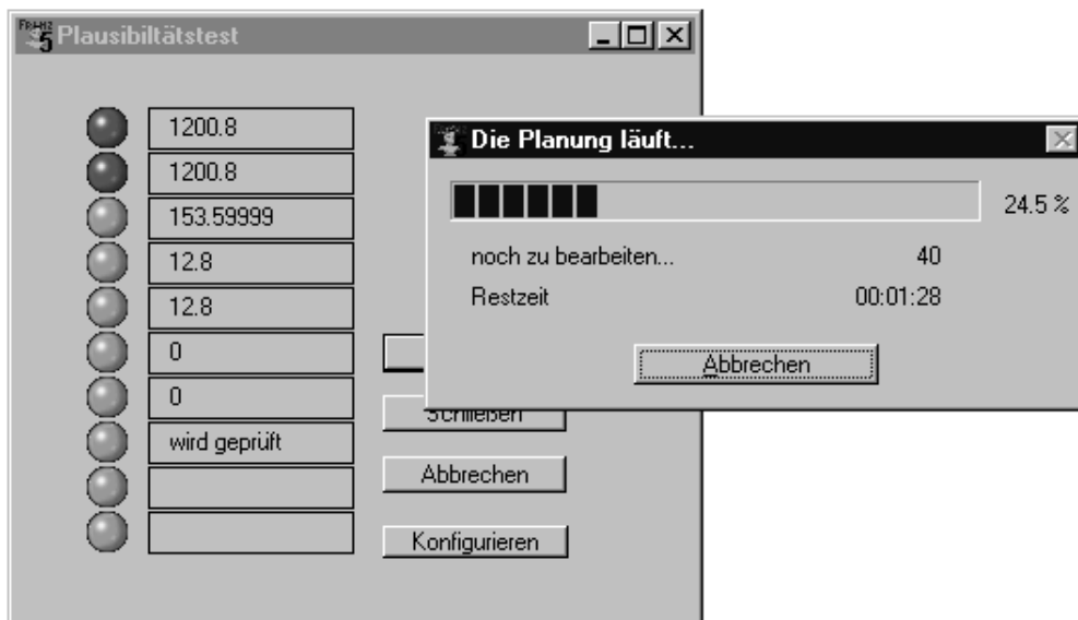
Abbildung 7.4: Beim Plausibilitätstest werden schrittweise Restriktionen weggelassen um festzustellen, ob das Problem mit weniger Restriktionen lösbar ist. Jede LED entspricht einem Restriktionsprofil. Diese werden der Reihe nach zur Zuordnung verwendet, wobei die LED Erfolg oder Misserfolg signalisiert .
