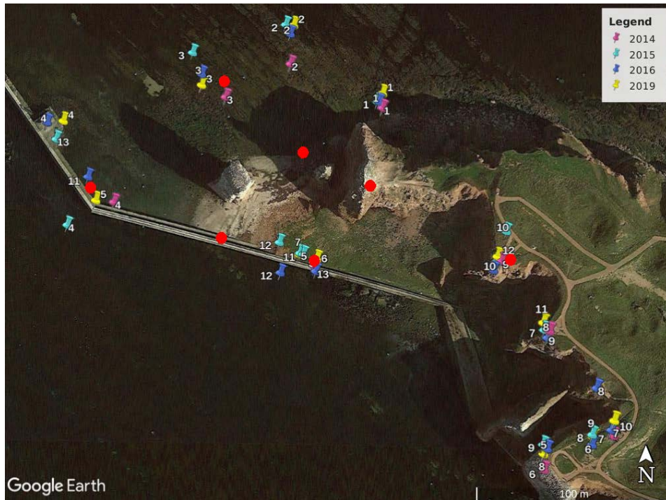
Abb. 2: Google Earth (GOOGLE 2020) Darstellung der Scanpositionen der Jahre 2014, 2015, 2016 und 2019, gemessen mit einem günstigen GPS-Empfänger, im Vergleich zu den Scanpositionen (rote Punkte) von LINDSTAEDT & KERSTEN (2005).
