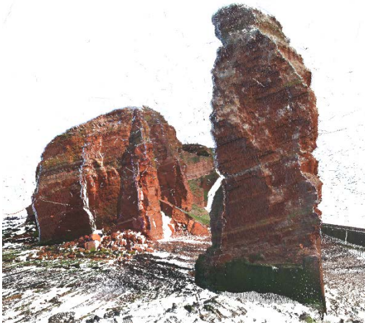
Abb. 3: Eingefärbte Punktwolke der Übersichtsscans aus dem Jahr 2014. Zur besseren Visualisierung wurde ein Teil der Vögel automatisch entfernt.
