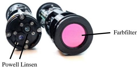
Abb. 3: Scannerkomponenten. Links: Kreuzlinienprojektor. Rechts: Monochrome Kamera mit Farbfilter (grüner Bandpassfilter).
