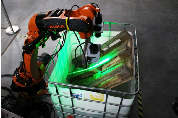
Abb. 1: Prototyp des Unterwasserlinienlaserscanners an einem KUKA KR-16 Manipulatorarm befestigt, um die halb im Wasser liegende Szene zu scannen.
