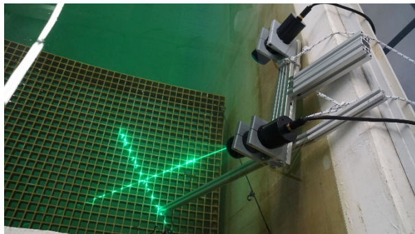
Abb. 2: Prototyp des Unterwasserlinienlaserscanners, der ein Kreuz in einen Wassertank projiziert.
