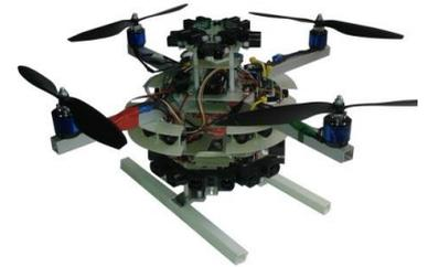
Der Lehrstuhl Informatik 8 (Aerospace Information Technology) entwickelt autonome Flugsysteme wie **Quadrocopter** für Aufgaben im Indoor-Bereich. Die Systeme sollen in die Lage versetzt werden selbstständig (autonom) zu agieren (z.B. Suchen durchführen). Die Quadrocopter werden am Lehrstuhl selbst gebaut und ständig weiterentwickelt. Darüber hinaus werden Quadrocopter und entsprechende Teststände in der Lehre eingesetzt.
