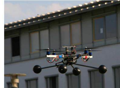
Der Lehrstuhl Informatik 8 (Aerospace Information Technology) entwickelt autonome Flugsysteme wie Quadrocopter für Aufgaben im Indoor-Bereich (Luftfahrtinformatik). Die Systeme sollen in die Lage versetzt werden selbstständig (autonom) zu agieren (z.B. Suchen durchführen). Die Quadrocopter werden am Lehrstuhl selbst gebaut und ständig weiterentwickelt. Darüber hinaus werden Quadrocopter und entsprechende Teststände in der Lehre eingesetzt.
