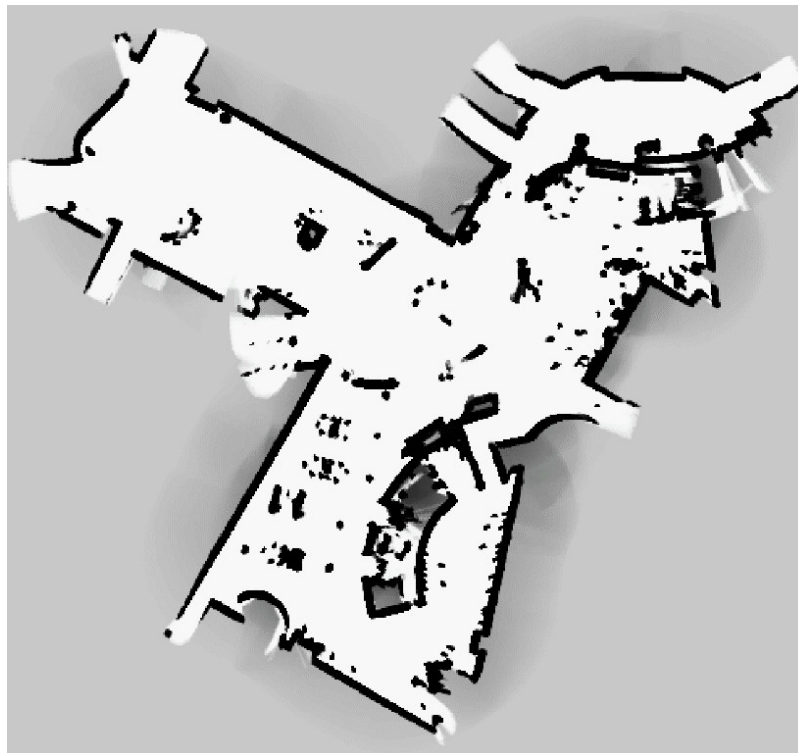
Abbildung 2.2.: Occupancy Grid Map einer großen Ausstellungsfläche. Je dunkler ein Pixel, desto wahrscheinlicher ist die zugehörige Zelle belegt. Quelle: Thrun et al. [2005]
