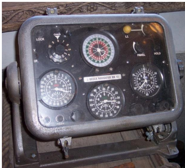
Abbildung 14: Decca Navigator MK12, eingesetzt ab 1962. Links oben befindet sich die Auswahl der Decca-Kette, mittig der Lane-Identifikator und darunter die drei Decometer Rot, Grün, Purpur (v.l.n.r.) [JPROG]
