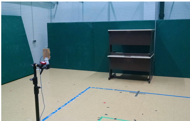
Abbildung 5.1.: Der Versuchsaufbau mit dem Radar im Vordergrund und den Tischen mit Metalloberfläche im Hintergrund
