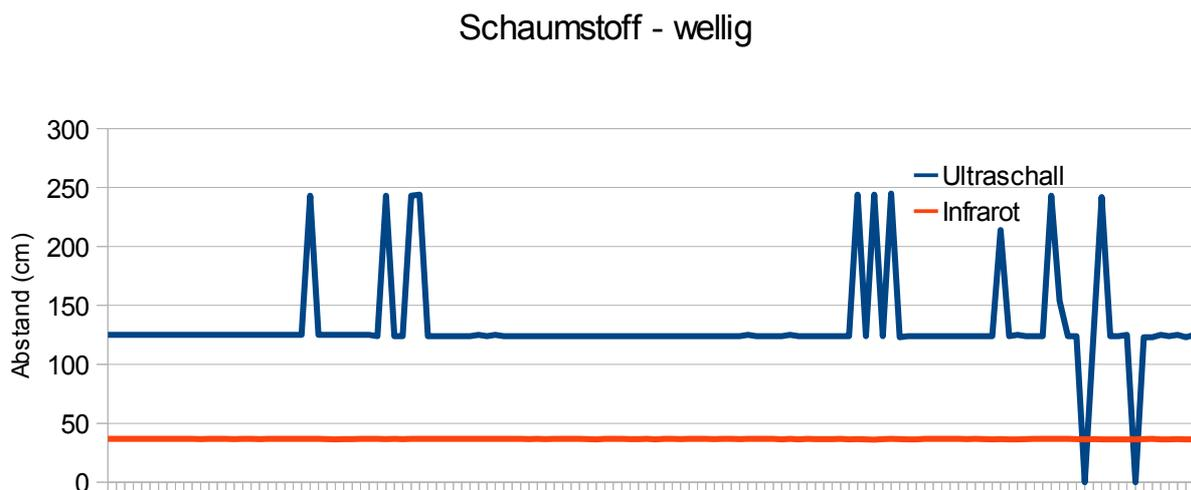
Abbildung 23: Distanzmessung zu Schaumstoff
