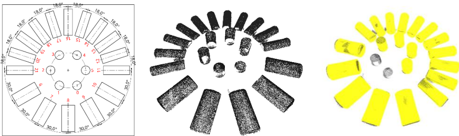
Abb. 5: Beispiel 2. Links: CAD-Zeichnung. Mitte: Realer Scan. Rechts: Detektierte Zylinder in gelber Farbe.
