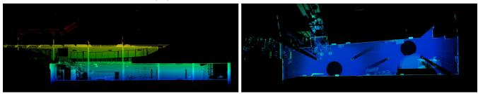
(d) Ground truth point cloud available from a RIEGL VZ-400 TLS
